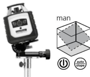
! LED de la función auto/slope encendido: alineación manual
