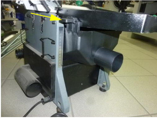
Fig. 6: Installation af spånsuger
