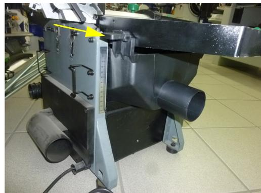
Abb. 8: Montage Späneabsaughaube
