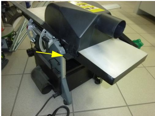
Abb. 12: Montage Späneabsaughaube
