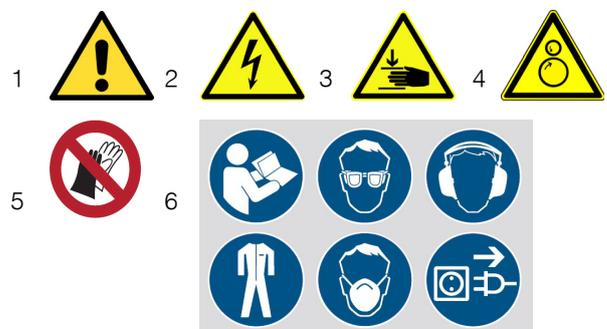
Abb. 1: Sicherheitskennzeichnungen
