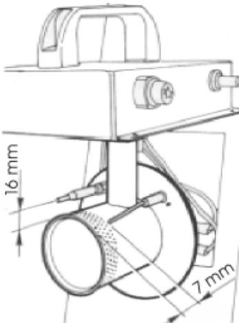
Verificar las distancias del electrodo y del termostato de seguridad. Intervenir solamente si fuese necesario.
