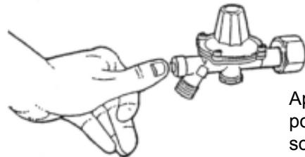
Appuyer sur le bouton pour rétablir la soupape de sécurité.
