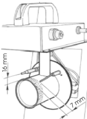
Provjeriti odstojanja elektrode i zaštitnog termostata.
