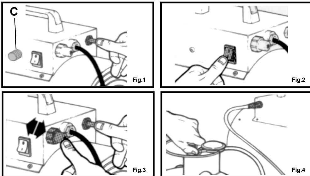
**NAPOMENA:** Toplinska se snaga podešava od najveće do najmanje vrijednosti pomoću ručnog kola (C) koje se nalazi na ploči generatora (samo za model SA PODEŠAVANJEM)
