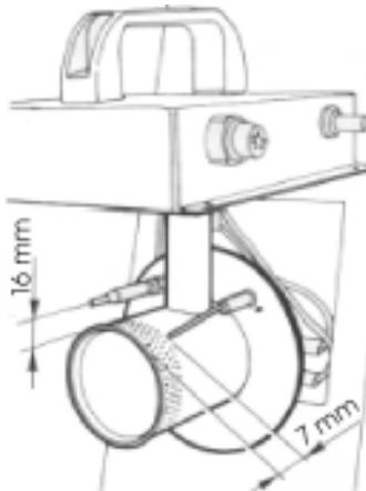
Verificare le distanze dell'elettrodo e del termostato di sicurezza. Intervenire solo se necessario.
