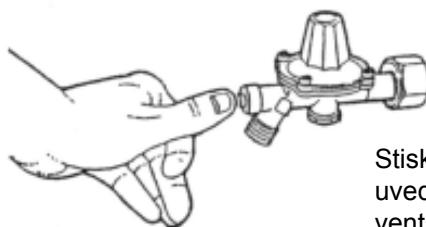
Stisknout tlačítko pro uvedení pojistného ventilu do původního stavu.
