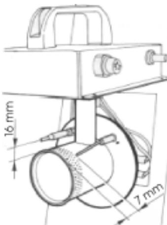
Skontrolujte vzdialenosť elektródy a bezpečnostného termostatu. Úpravu urobte, iba ak je to nevyhnutné.
