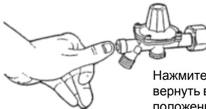
Нажмите кнопку, чтобы вернуть в исходное положение предохранительный клапан.
