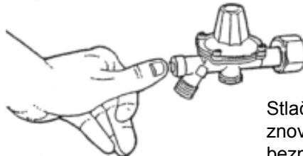
Stlačte tlačidlo, aby sa znova spustila ochrana bezpečnostného ventilu.
