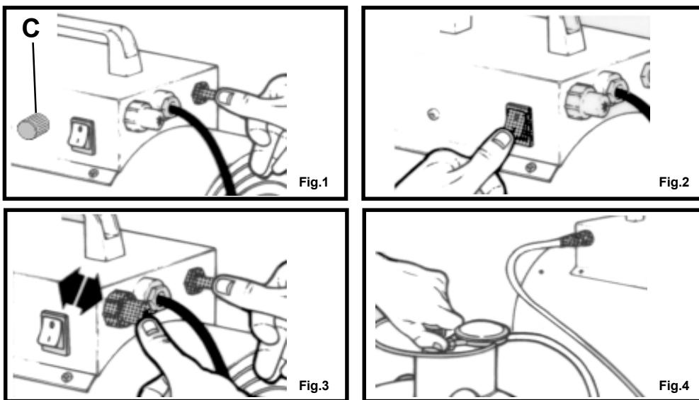
**ЗАМЕЧАНИЕ !** Тепловая мощность регулируется от максимума до минимума с помощью круглой рукоятки ( С ), расположенной на панели теплового генератора (только в моделях с РЕГУЛИРОВАНИЕМ).
