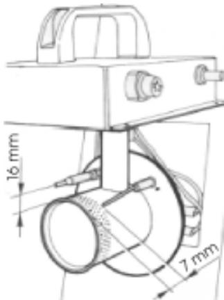
Controleer de afstanden van de elektroden en van de veiligheidsthermostaat. Grijp alleen in indien dit nodig is.
