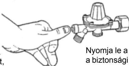
Nyomja le a nyomógombot a biztonsági szelep visszaállításához.
