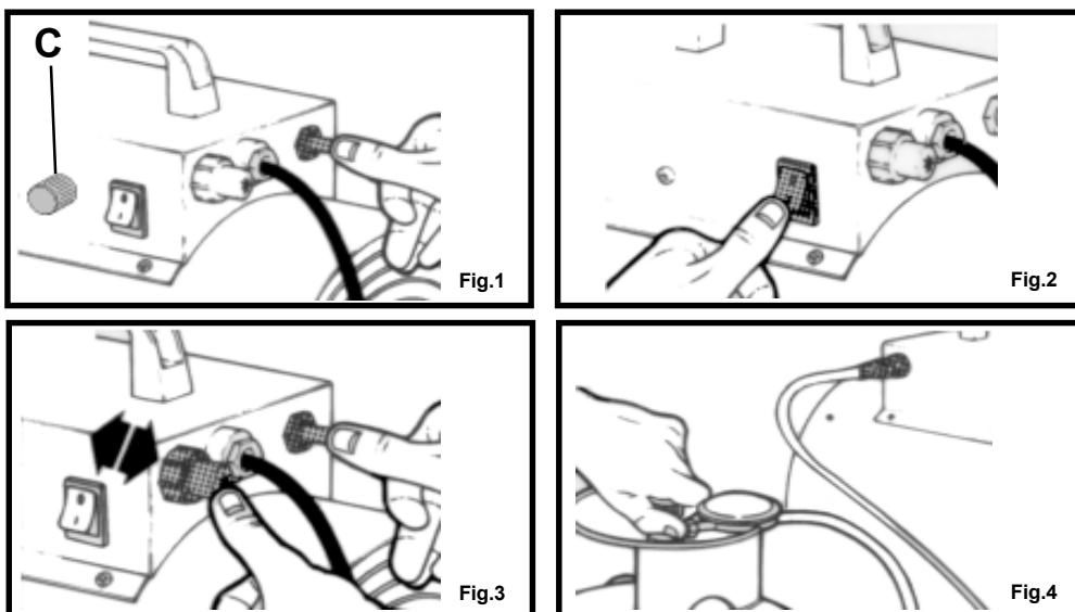
**N.B. Moc cieplną można regułować od wartości max. do wartości min. za pomocą ( C ) pokrętła na płycie generatora ( tylko model Z REGULACJĄ)**
