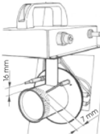
Проверьте расстояния до электрода и редоохранительного термостата. В случае необходимости измените положение.
