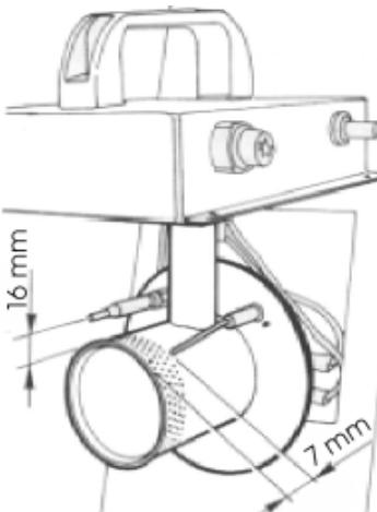
Preverite razdalje elektrode in varnostnega termostata.
