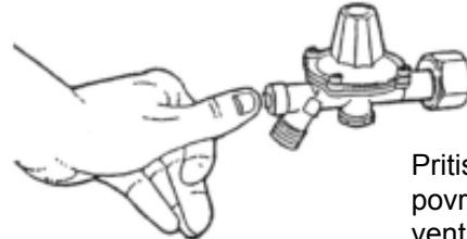
Pritisnite gumb za povrnitev varnostnega ventila v prvotno stanje.
