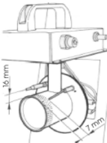
Kontrollera avstånden på elektroden och säkerhets-termostaten. Ingrip bara om nödvändigt.
