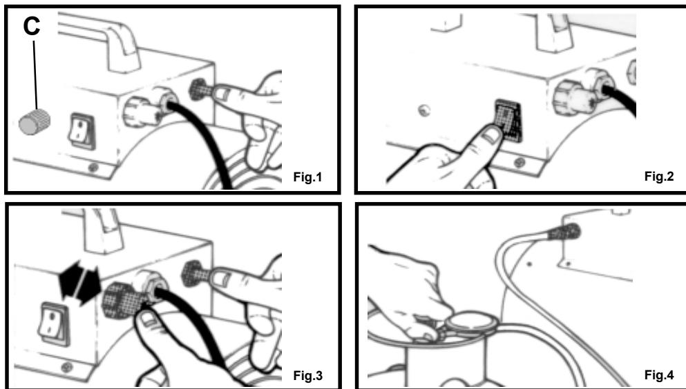
**HUOM!** Lämpöteho on säädettävissä maksimi- ja minimiarvon välille laitteen käyttöpaneelilla olevan käsipyörän avulla (vain SÄÄDETTÄVÄ malli).
