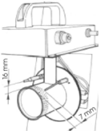
Zkontrolovat vzdálenost mezi elektrodou a bezpečnostním termostatem. Provést pouze nezbytné úkony.
