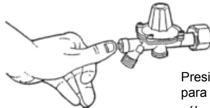
Presionar el botón para restablecer la válvula de seguridad.
