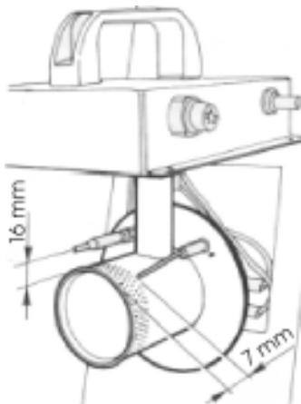
Kontrollér elektrodens og sikkerhedstermostatens afstande. Grib kun ind, hvis det kræves. Tryk på trykknappen for genopretning af sikkerhedsventilen.
