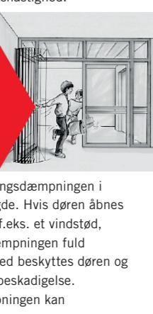
Åbnes døren hurtigere, aktiveres åbningsdæmpningen i doseret mængde. Hvis døren åbnes kraftigt op af f.eks. et vindstød, får åbningsdæmpningen fuld virkning. Herved beskyttes døren og væggen mod beskadigelse. Åbningsdæmpningen kan kobles til / fra.
